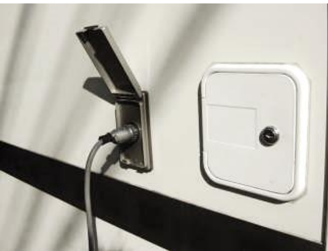
●外部電源口・取水口
