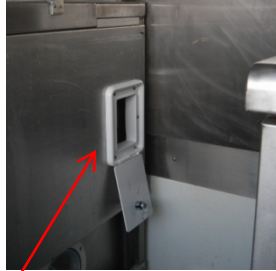
【モード切替弁】 タンクor水道直結 を選択 (右・赤いノブ)
