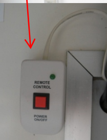
【インバーター(内部電源)】 車両用バッテリーから 100Vに変換します。 (左・コントロールスイッチ)
