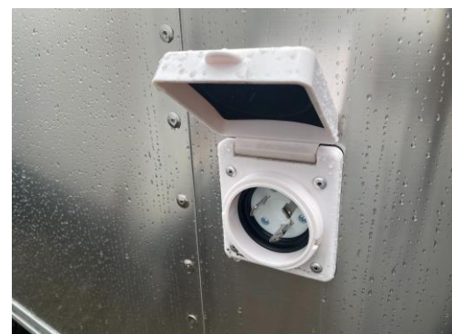
● 外部電源引き込み口
